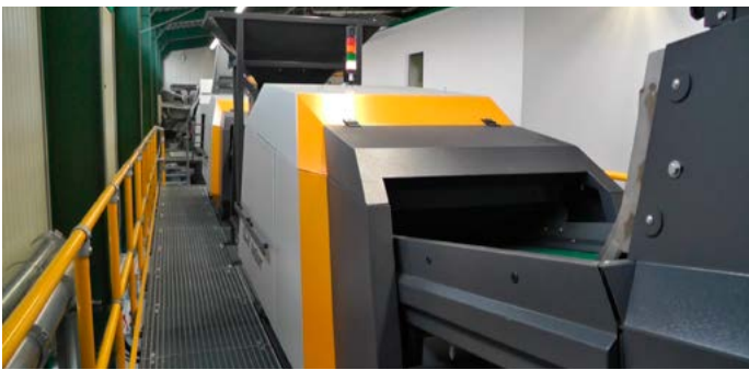
UNISORT BlackEye nel processo di separazione
