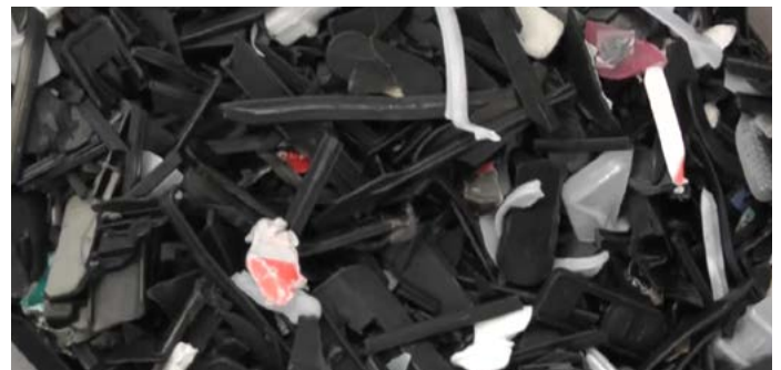
PP/PS Gemisch - zerkleinerte Kleiderbügel
