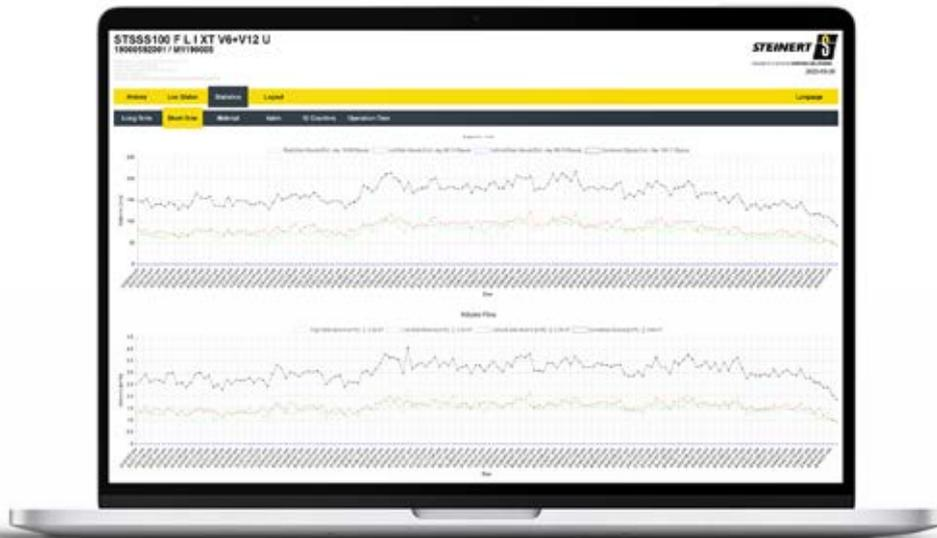
**STEINERT.dashboard** ist eine detaillierte Monitoringlösung für STEINERT-Sensorsortiersysteme. Sie ermöglicht ihren Usern eine Visualisierung von Betriebs- und Produktionszahlen, wie Bandbelegung, Volumenstrom, Objektrate, Korngrößenverteilung, gewähltes Sortierprogramm und vieles mehr, um die aktuelle Leistungsfähigkeit der eigenen Sortieranlage und ihrer Anwendungen zu analysieren.
