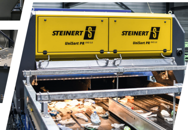
Separação de materiais recicláveis 3D por meio do UniSort PR EVO 5.0 e programas de separação baseados em IA
