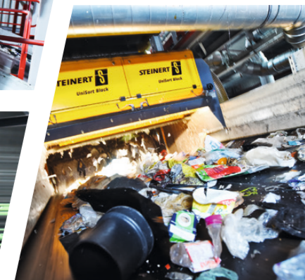
Separação de plásticos pretos usando o UniSort Black
