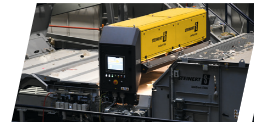
Separação de plásticos 2D por meio do UniSort Film EVO 5.0
