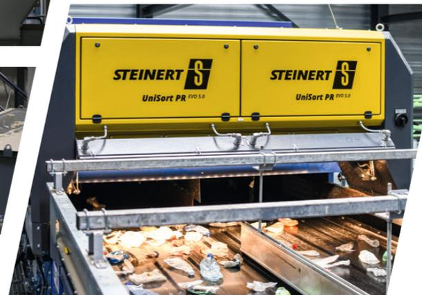
Separación de materiales reciclables en 3D mediante UniSort PR EVO 5.0 y programas de separación basados en la IA
