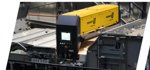
Separación de plásticos en 2D mediante UniSort Film EVO 5.0
