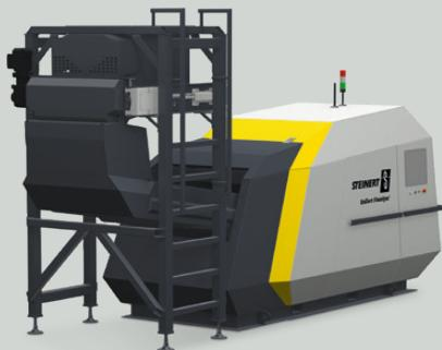
Le système UniSort Finealyse a été spécialement développé pour le tri de matière en vrac à grains fins. Il est idéal pour une utilisation dans le traitement des métaux, notamment pour la séparation d'un mélange de métaux non ferreux rouges, jaunes et gris. Des degrés de pureté extrêmement élevés sont atteints lors du tri du cuivre/aluminium. Il est également possible d'intégrer une fonction de détection tous métaux.
