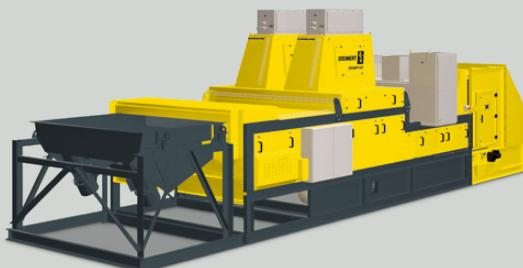
Outre la détection par capteurs des métaux et des informations de forme et de couleur, la machine de tri détermine également la composition élémentaire de chaque objet à l'aide de la fluorescence de rayons X (XRF).
