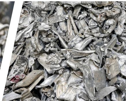
STEINERT PLASMAX | LIBS permite la separación eficiente de chatarra de aluminio en hasta tres productos diferentes en un solo paso. Esta solución permite a las empresas de reciclaje producir de manera específica clases de aleaciones de gran calidad listas para el horno.
