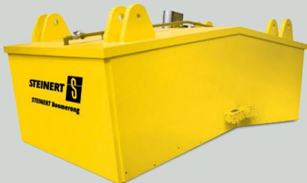
Le STEINERT Boomerang (poids net : 43 t) est conçu pour la séparation de fer étranger indésirable et d'éléments grossiers tels tiges et dents de godets hors des minéraux ou du charbon, avec de grands flux massiques. À cet effet, il est suspendu au-dessus de la poulie de tête d'une bande transporteuse. Avec sa forme caractéristique, il y suit de manière idéale la parabole de déversement du flux de matière.
