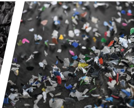
El UniSort BlackEye es el primer sistema de separación del mundo que trabaja de forma rentable con plásticos negros. Mediante una unidad de sensor especial, el equipo es capaz de detectar de forma segura y separar con precisión los tipos de plásticos claros y negros.
