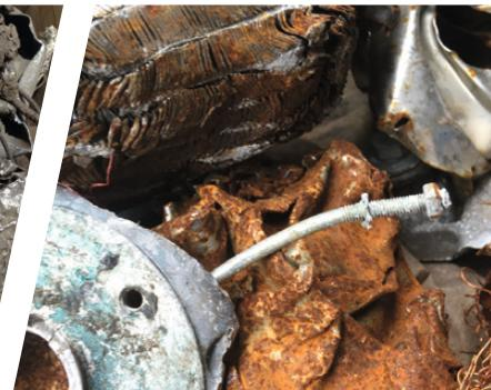
El STEINERT SteelMaster utiliza una combinación de efectos balísticos y magnéticos para separar compuestos que contienen cobre, los llamados «meatballs» (inductores o bobinas de motores), de una fracción férrica pesada. Con esta máquina separadora se recuperan bobinas de cobre con núcleo de hierro (rotor de cobre o «meatballs») de un flujo de material.
