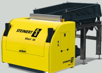
Le système MSort AX est la solution parfaite pour le tri par couleurs par voie humide et sèche du verre creux ou plat. Le système de tri très robuste sépare le verre dans la plage granulométrique de 6 à 60 mm avec la plus haute précision. La détection par induction et la possibilité de tri qui s'en dégage pour les métaux ferreux et non ferreux, avec une sensibilité réglable, est disponible en option et rétrofittable à tout moment.
