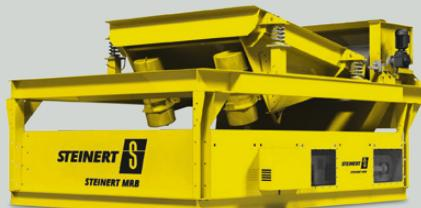
Le STEINERT MRB est utilisé pour le tri des métaux ferromagnétiques à grains fins. Le séparateur magnétique à deux étages combine un tambour magnétique alimenté par le bas STEINERT MTP, avec une poulie magnétique STEINERT MSB alimentée par le haut. Tandis que le premier génère de la ferraille à forte valeur ajoutée, la deuxième sépare les composants faiblement magnétisables.
