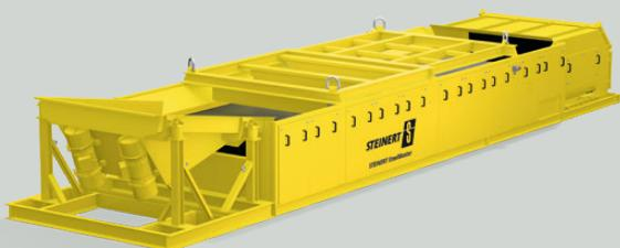
Le STEINERT SteelMaster utilise une combinaison d'effets balistiques et magnétiques pour la séparation des déchets mélangés contenant du cuivre, à partir d'une fraction de fer lourde. Cette machine de tri permet de concentrer les bobines en cuivre avec noyau en fer (induits ou « meatballs ») dans un flux de matière.
