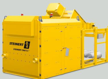
La STEINERT CHUTEC est utilisée pour le tri de métaux lourds non ferreux (ZEBRA) provenant des mâchefers ou des résidus de broyage automobile (RBA). Ce système de tri assure, en particulier pour les petites granulométries de 5 à 30 mm, la séparation des métaux lourds tels que le cuivre, le zinc, le laiton ou l'acier inoxydable. Il peut être utilisé pour produire des concentrés de différents métaux répondants qualitativement et directement aux besoins des fonderies de transformation.
