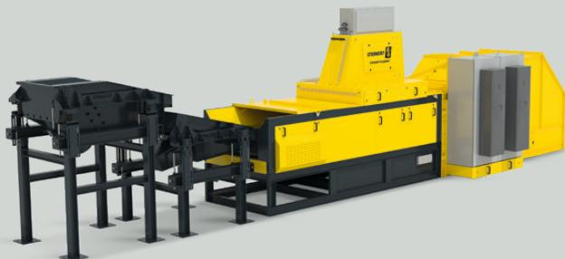
Le système STEINERT PLASMAX | LIBS permet la séparation efficace des déchets d'aluminium pour obtenir jusqu'à trois différents produits triés en une seule opération. Cette solution permet aux entreprises de recyclage de produire spécifiquement des classes d'alliage de grande qualité prêtes pour la fusion.
