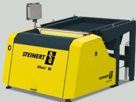
La machine de tri MSort BE, qui offre un excellent rapport qualité-prix, convient pour le tri par couleur du verre creux et plat humide ou sec, ainsi que pour la séparation de la céramique, des pierres et de la porcelaine (CPP) du verre, jusqu'à 12 t/h au maximum, dans une plage granulométrique standard de 8 à 60 mm. Un rétrofit de la détection inductive est par ailleurs possible. Cette dernière permet l'extraction de métaux ferreux et non ferreux à partir de 0,8 mm avec une extrême sensibilité.
