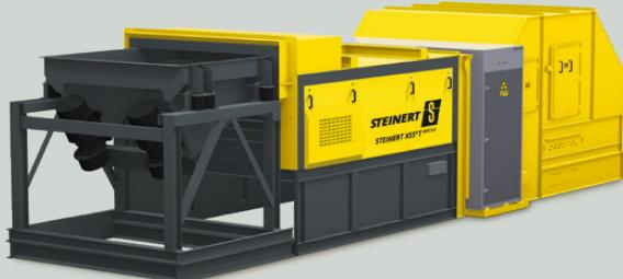
Le système de tri par rayons X STEINERT XSS T EVO 5.0 est utilisé pour le tri par voie sèche de matière en vrac en fonction de sa densité. Dans un procédé de transmission de rayons X, les différences d'absorption de rayons X par les matériaux sont détectées et utilisées pour séparer la matière selon des classes de densité.
