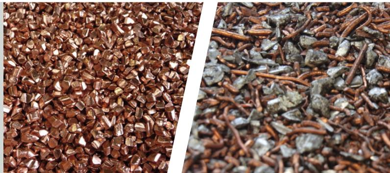
UniSort Finealyse ha sido especialmente desarrollado para la separación de material a granel fino. Es ideal para su uso en el tratamiento de metales cuando se requiere separar los rojos, amarillos y grises de una mezcla de metales de color. En la separación de cobre y aluminio se alcanzan grados de pureza extremadamente altos. Opcionalmente se puede integrar la detección de todos los metales.
