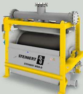
Le WDB-D est un tambour magnétique qui a été spécialement développé comme unité de déshydratation pour une utilisation dans les installations de déshydratation de magnétite. Il s'utilise aussi parallèlement aux installations de déshydratation existantes.
