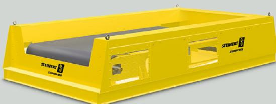
Le séparateur à poulie magnétique STEINERT MSB se compose d'un convoyeur avec une poulie magnétique de type STEINERT BR. Il est équipé selon le cas d'application d'aimants permanents ou de bobines électromagnétiques. Si le champ magnétique au niveau du tambour de tête est constant, le résultat du tri est commandé principalement par le réglage de la vitesse de la bande transporteeuse et par la position du ou des volet(s) de séparation.
