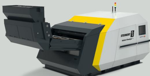
Le système UniSort Finealyse+ a été spécialement développé pour le tri des matières en vrac à grains fins telles que les mélanges de plastiques. La nouvelle génération offre aux utilisateurs de nombreuses améliorations matérielles et une fusion de capteurs composée d'une caméra proche infrarouge (NIR) et d'une caméra couleur à haute résolution.
