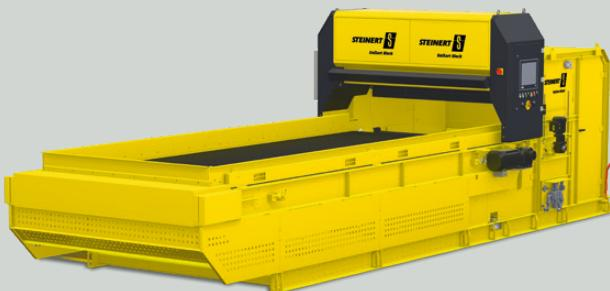
L'UniSort Black repose sur l'utilisation de la technologie à imagerie hyperspectrale (HSI). Elle permet la détection fiable de tous les matériaux détectables par rayonnement proche infrarouge (NIR). La disposition spéciale et la classification adaptée permettent à l'UniSort Black de détecter en plus les objets sombres, voire noirs. Ces derniers restent sinon invisibles pour les machines de tri NIR standard.
