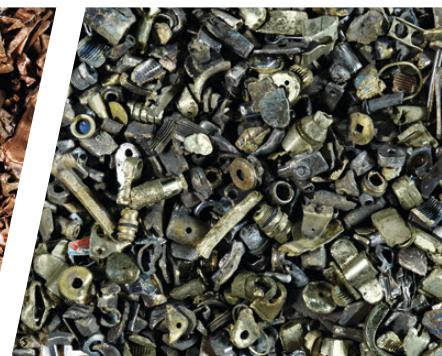
Los campos de aplicación de la separación por color son, por ejemplo, la separación de concentrados de metales pesados no férricos de cobre, latón o metales grises, así como la separación de minerales industriales.
