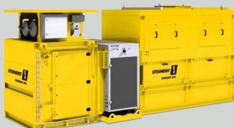
Les pierres spéciales, telles que les diamants, exigent une conception particulière. C'est pourquoi le système de tri par transmission de rayons X a été adapté, et la STEINERT XTS conçue pour répondre aux exigences spécifiques du tri des diamants. Il offre ainsi la norme de sécurité nécessaire pour cette étape du traitement dans le tri des diamants.
