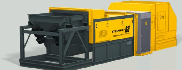
Das Röntgensortiersystem STEINERT XSS T EVO 5.0 wird für die trockene Dichtesortierung von Schüttgütern eingesetzt. In einem transmittierenden Verfahren werden dabei materialabhängige Unterschiede in der Absorption von Röntgenstrahlung detektiert, klassifiziert und zur Sortierung in Dichteklassen genutzt.
