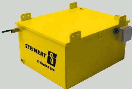
Der STEINERT MP Range ist mit Elektromagneten ausgestattet, kommt aber ohne aufwendige Steuerung mit großem Gleichrichter aus. Er lässt sich direkt an die Hauptstromversorgung anschließen, was eine schnelle Inbetriebnahme ermöglicht und Platz einspart, da der Steuerungsschrank komplett entfällt. Unseren STEINERT MP Range bieten wir als selbstreinigenden Überbandmagnetscheider mit umlaufenden Gurt an, und als reinen Aushebemagneten mit manueller Reinigung.
