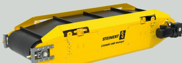
Der STEINERT UMP Multipol ist die innovative Lösung zur Anreicherung bzw. Reinigung von FE-Konzentraten. Bei diesem permanent-magnetisch arbeitenden Überbandmagnetscheider sorgen wechselnde Magnetpole dafür, dass Störstoffe effektiv entfernt werden, wodurch die Qualität von FE-Fraktionen steigt und Kupferverluste in WEEE-Anwendungen sinken. Diese Technologie kann leicht in bestehende Anlagen integriert werden und bietet eine kosteneffiziente Alternative zu herkömmlichen Reinigungsmethoden.
