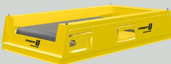
Der Magnetbandrollenscheider STEINERT MSB besteht aus einem Förderband mit magnetischer Bandrolle des Typs STEINERT BR. Diese ist passend zum Einsatzfall mit Permanentmagneten oder elektromagnetischen Spulen bestückt. Bei gleichbleibendem Magnetfeld am Kopf der Trommel wird das Sortierergebnis hauptsächlich über die Geschwindigkeit des umlaufenden, frequenzgeregelten Fördergurtes und die Position des oder der Trennscheitel gesteuert.
