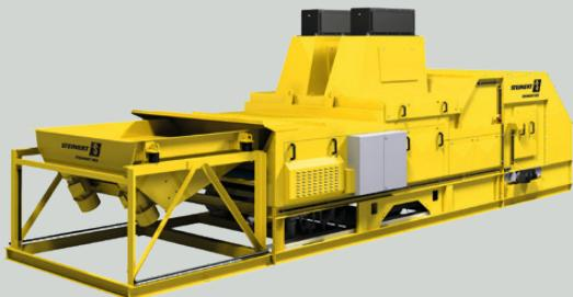
Mit der Kombination von Farb-, 3D und Metallerkennung lassen sich viele Aufgabenstellungen lösen. Häufig kann über die Ausnutzung von sensorisch erfassten Sekundärmerkmalen, wie bestimmter Formen oder Farbinformationen, auf zu unterscheidende Materialien geschlossen werden. Eine logische Verknüpfung dieser Merkmale führt dann zu einer Materialzuordnung und im Ergebnis zu einer Anreicherung bestimmter Materialien in einer Produktfraktion.
