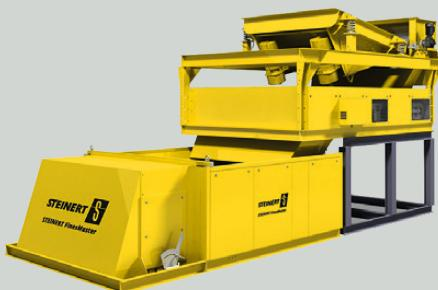
Das Besondere am STEINERT FinesMaster ist die kompakte Verbindung bewährter Sortiermodule in einer einzigen Einheit ohne lange Förderstrecken und Übergabestellen. Modul 1 besteht aus einem zweistufigen Magnetscheider (MRB) und dient der Rückgewinnung von Feineisen und der Abtrennung von schwach magnetischem Störstoff. Modul 2 enthält den Hochfrequenz-Wirbelstromscheider NES 6119 mit seinem einzigartigen exzentrischen und verstellbaren Polsystem für feine NE-Metalle.
