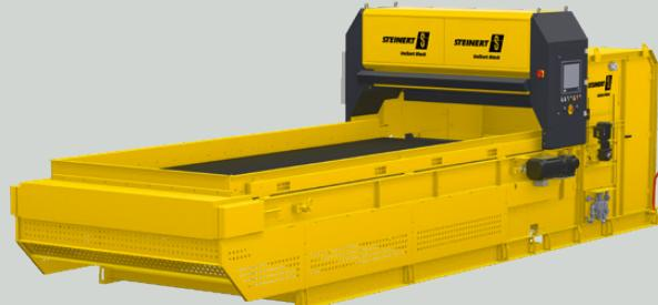
Die UniSort Black basiert auf dem Einsatz der HSI-Kamera-technik. Damit können alle mit NIR detektierbaren Materien zuverlässig erkannt werden. Durch die spezielle Anordnung und angepasste Klassifizierung kann die UniSort Black zusätzlich dunkle oder sogar schwarze Objekte erkennen. Letztere bleiben sonst für Standard-NIR-Sortierer unsichtbar.
