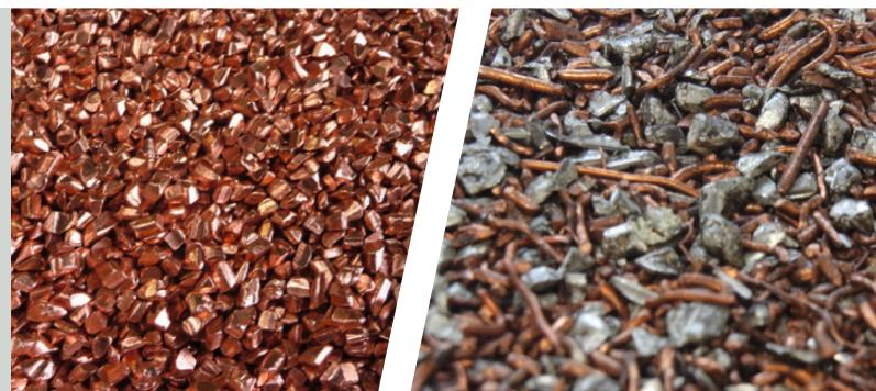
UniSort Finealyse wurde speziell für die Sortierung feinkörniger Schüttgüter entwickelt. Es eignet sich ideal für den Einsatz in der Metallaufbereitung, wenn es darum geht, ein Buntmetallgemisch von Rot, Gelb und Grau zu trennen. Bei der Kupfer-Aluminium-Sortierung werden extrem hohe Reinheitsgrade erreicht. Optional kann eine Allmetallerkennung integriert werden.
