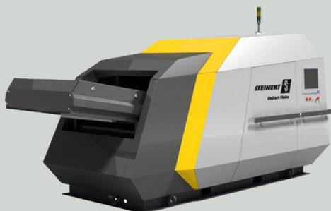
UniSort Finealyse wurde speziell für die Sortierung von feinen Schüttgütern, wie z.B. Kunststoffgemischen entwickelt.
