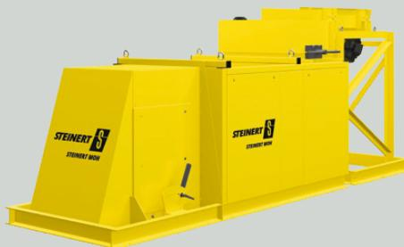
Der STEINERT MOH ist ein Kombinationsscheider bestehend aus einer STEINERT MTP und einem STEINERT Wirbelstromscheider und vereint damit in kompakter Bauform zwei Sortierstufen. Diese Verfahrensanordnung ist speziell für mittlere Korngrößenbereiche konzipiert.
