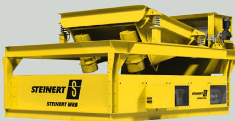
Mit dem STEINERT MRB werden ferromagnetische Metalle im Feinkornbereich ausgebracht. Der zweistufige Magnetscheider kombiniert eine aushebende Magnettrommel STEINERT MTP mit einer überlaufenden Magnetbandrolle STEINERT MSB. Während Erstere werthaltigen Eisenschrott erzeugt, trennt die Magnetbandrolle im zweiten Schritt schwach magnetisierbare Bestandteile ab.
