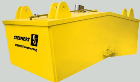
Der STEINERT Boomerang (Nettogewicht: 43 t) ist konzipiert für die Separation von störendem Fremdeisen und Grobteilen, wie Stangen und Baggerzähnen aus Erzen oder Kohle mit großen Massenströmen. Er wird dafür in den Abwurf einer Fördergurttrommel gehängt. Dort folgt er mit seiner charakteristischen Form ideal der Abwurfparrabel des Materialstroms.
